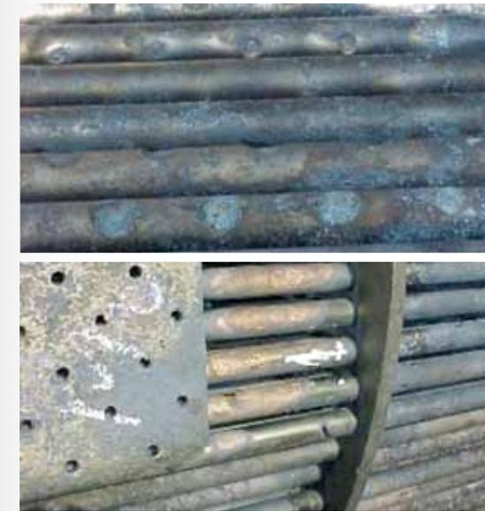
**Fig. 3** Daños en tubos y placa de choque. Superior: Debajo de la placa de choque. Inferior: Daño sobre la placa de choque y en su periferia.
